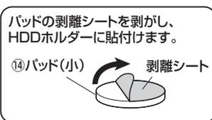
パッドの剥離シートを剥がし、HDDホルダーに貼付けます。
