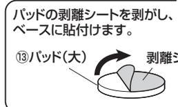
パッドの剥離シートを剥がし、ベースに貼付けます。
