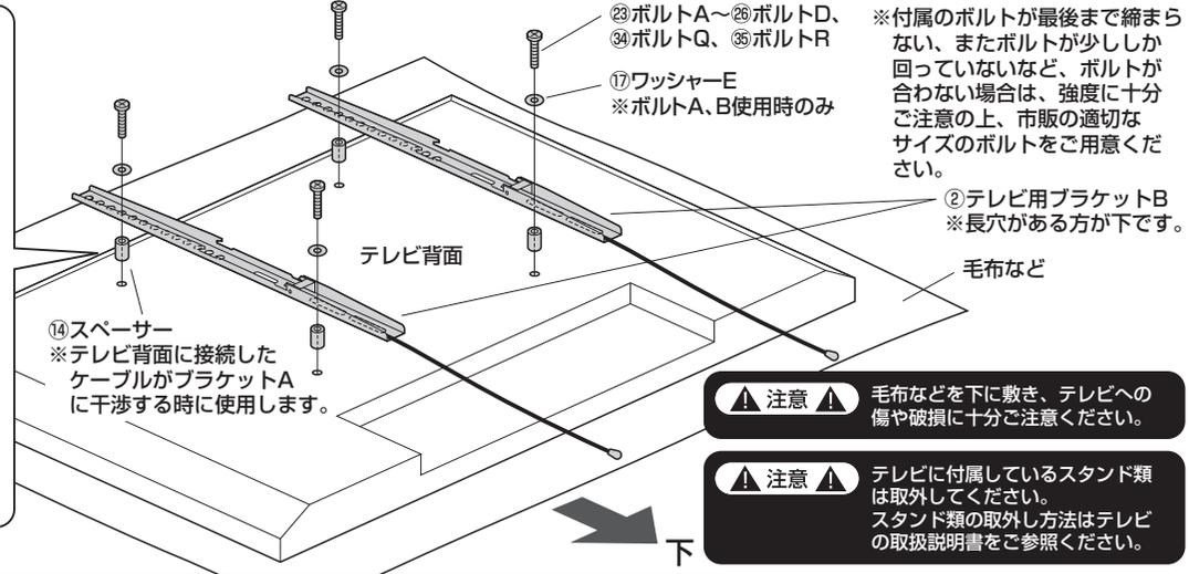
※付属のボルトが最後まで締まらない、またボルトが少ししか回っていないなど、ボルトが合わない場合は、強度に十分ご注意の上、市販の適切なサイズのボルトをご用意ください。
