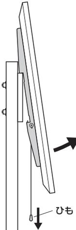
②テレビ用ブラケットAの高さを調節し、再度テレビ用ブラケットBを取付けます。
