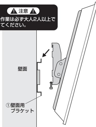
③ ディスプレイ用ブラケットの落下防止ボルトを締めます。
