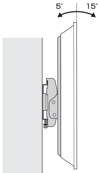
① 一旦壁面から取外してディスプレイ用ブラケットのナットをゆるめます。
