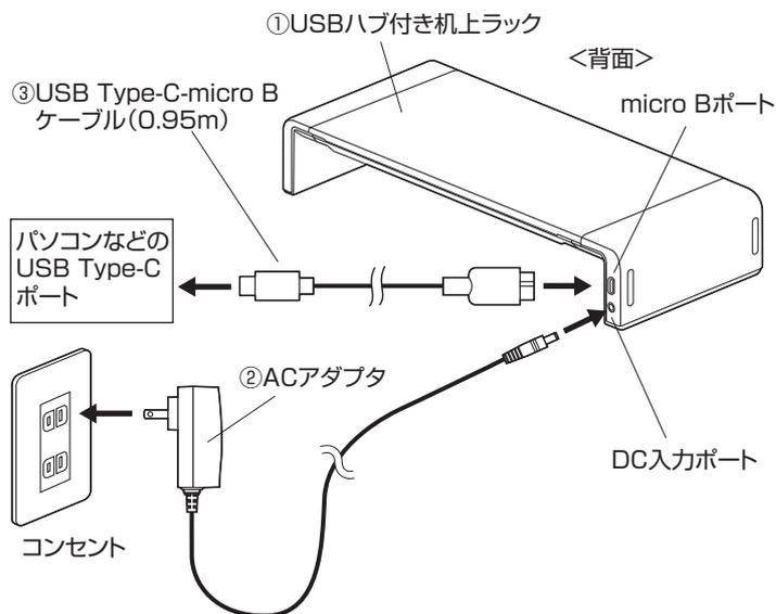
※前面のポートに接続した機器の安定した動作の為にACアダプタを接続してご使用ください。
