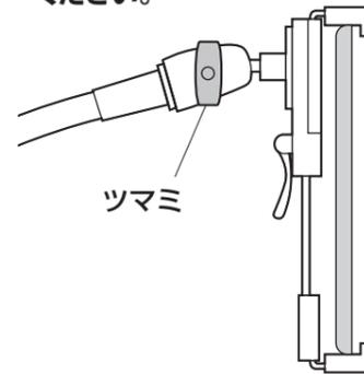
※角度調整後、確実に締め付けてください。
