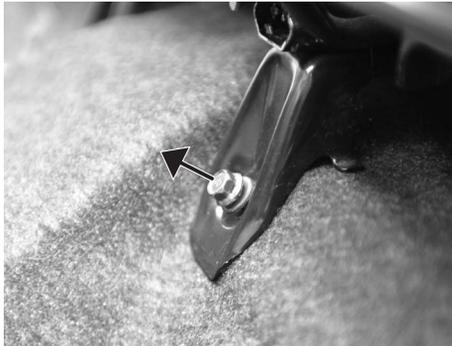
③ 取外したボルトでブラケットを取付けます。
