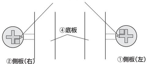
②プラスドライバーで矢印の方向に回し、締め込みます。
