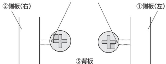
②プラスドライバーで矢印の方向に回し、締め込みます。
