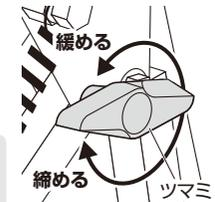
アームの角度を固定できない場合は付属のスパナでナットを締め付けて調節します。
