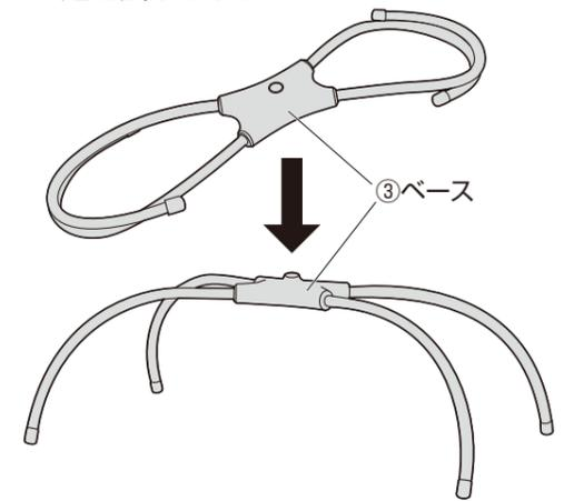
**5** アーム接続部にベース接続部を挿入します。
