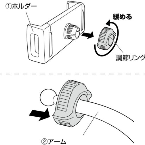
**2** ボールジョイントをホルダーに取り付け(A)、調整リングを回して固定します。(B)
