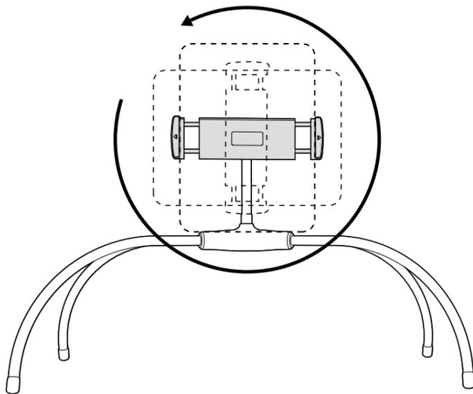
**4** ベース部分の脚とフレキシブルアームを自由に変形させて高さを調節します。
