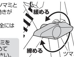
アームの角度を固定できない場合は付属のスパナでナットを締め付けて調節します。
