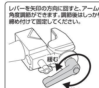
レバーを矢印の方向に回すと、アームの角度調節ができます。調節後はしっかりと締め付けて固定してください。
