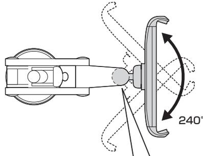
アームの動きが軽すぎたり、重すぎる場合はキャップを外し、六角レンチ (4mm) でネジを回して調節します。
