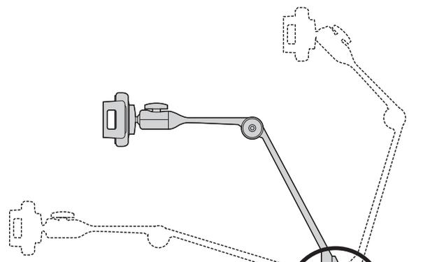
アームの動きが軽すぎたり、重すぎる場合は六角レンチ(中)でクランプ内のネジ(中央)を回して調節します。
