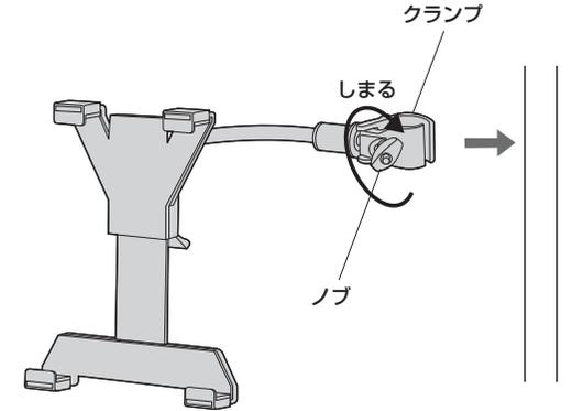
※クラмпでパイプを挟みノブを回して固定します。
