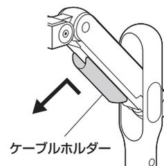
②ケーブルを通した状態で差し込み取付けます。
