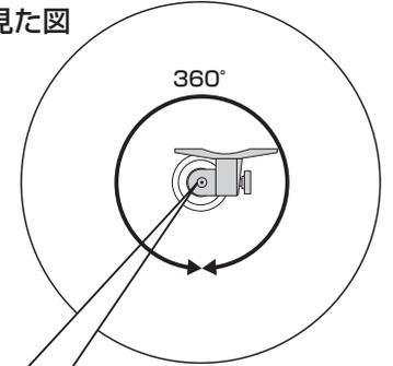
ブラケットの動きが軽すぎる場合、六角レンチでボルトを締め付けて調節します。
