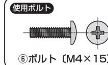
※付属のボルトが最後まで締まらない、またボルトが少ししか回っていないなど、ボルトが合わない場合は、強度に十分で注意の上、市販の適切なサイズのボルトをご用意ください。
