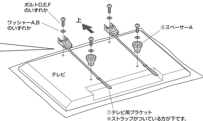
※付属のボルトが最後まで締まらない、またボルトが少ししか回っていないなど、ボルトが合わない場合は、強度に十分ご注意の上、市販の適切なサイズのボルトをご用意ください。
