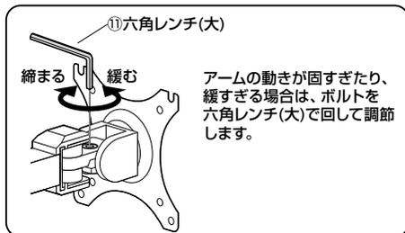
アームの動きが固すぎたり、緩すぎる場合は、ボルトを六角レンチ(大)で回して調節します。
