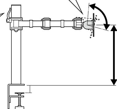
このボルトの調節用工具は付属していません。適切な固さに調節して出荷しておりますが、固さを調節したい場合は、市販の六角レンチ(No.6)とスパナ(13mm)で回して調節してください。
