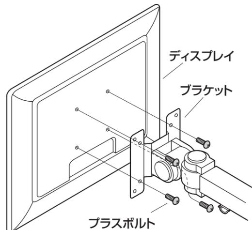
※ボルトが最後まで締まらない、またボルトが少ししか回っていないなど、ボルトが合わない場合は、強度に十分ご注意ください。市販の適切なボルトをご用意ください。
