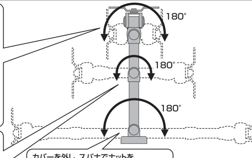
カバーを外し、スパナでナットを締め付けて固さを調節します。
