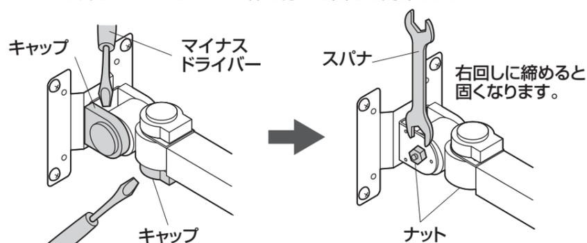
キャップを外し、スパナでナットを締め付けて固さを調節します。
