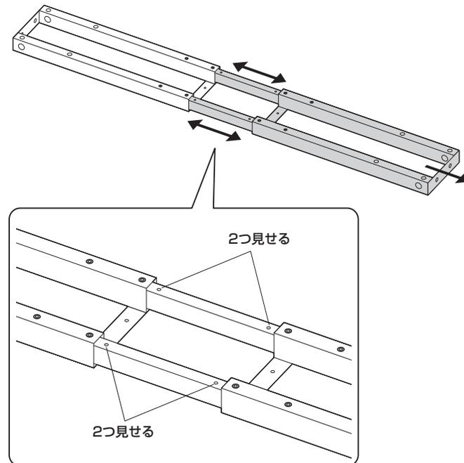
③下図のボルトを締め付けて固定します。
