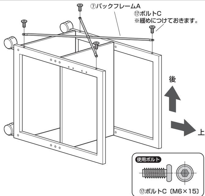
**8** フレームCにバックフレームBを取付けます。
