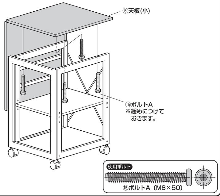
11 緩めにつけていた全ての木ネジ、ボルトを締め付けて完成です。
