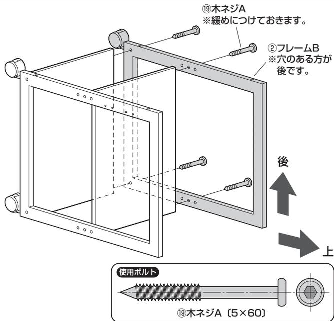
**7** バックフレームAを取付けます。
