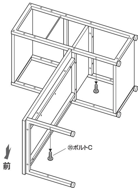
②脚の位置を調節し、補強バーと一緒に固定します。
