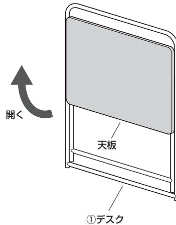
②フレームを接地させて天板を水平にします。
