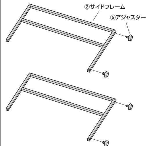
**2 サイドフレームにパイプフレーム(小)を取付けます。**
