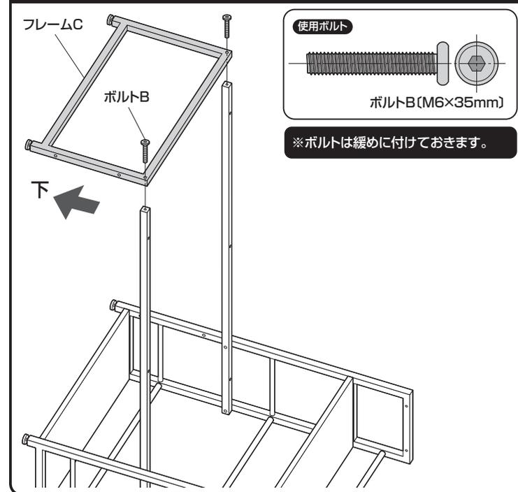
**9** バックフレームを取付けます。
