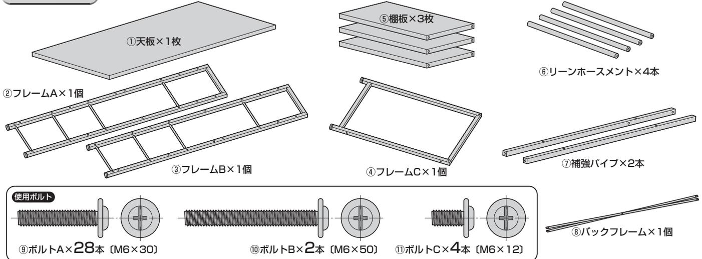
**1 フレームA・Bに棚板を取付けます。**
