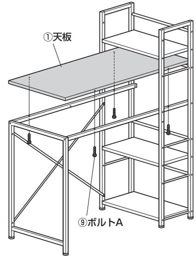
※天板取付け後、全てのボルトを締め込みます。
