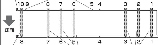
一番下には必ず取付けてください。 3ヶ所のいずれかに1枚取付けてください。 1～3のいずれかに1枚取付けてください。
