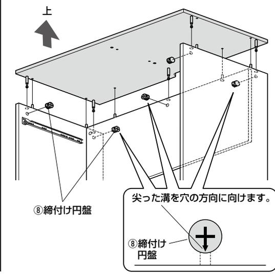
③締め付け円盤を回して固定します。
