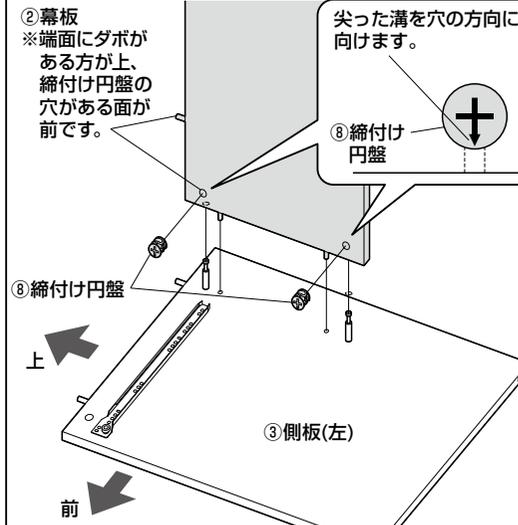
③締付け円盤を回して固定します。
