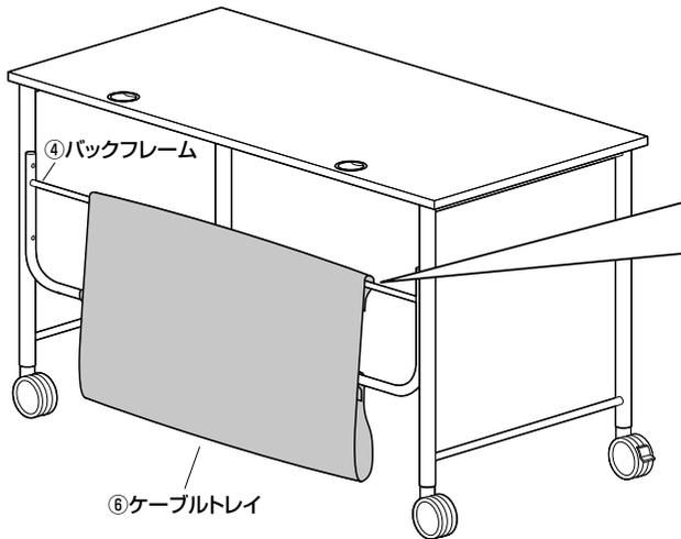
①ケーブルトレイの片側をバックフレームの上側に巻き付け、面ファスナーで止めます。
