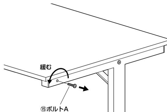
(2) フックを取外したボルトAで取付けます。
