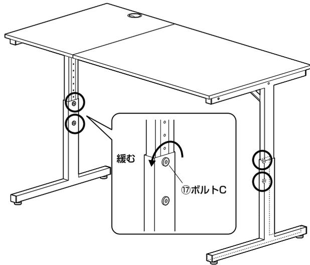
(2) 天板を水平にし、緩めていたボルトC4本を締め付けます。
