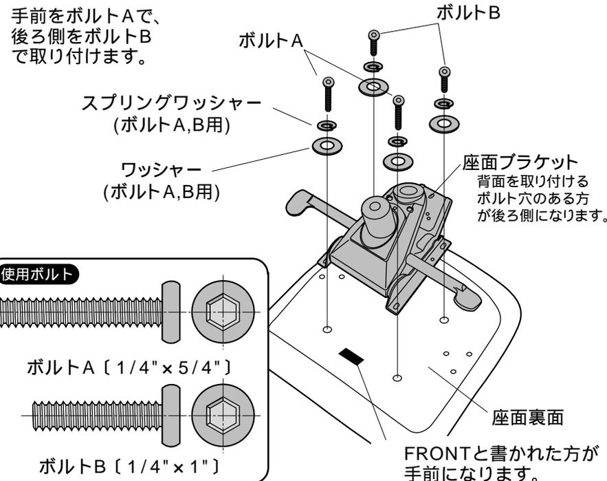
4 ガスシリンダーに座面を差し込みます。
