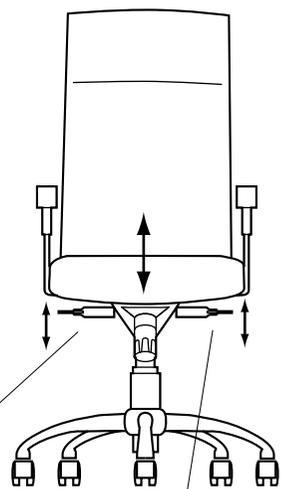
・向かって左側のレバーを引き上げると座面の高さ調節ができます。
