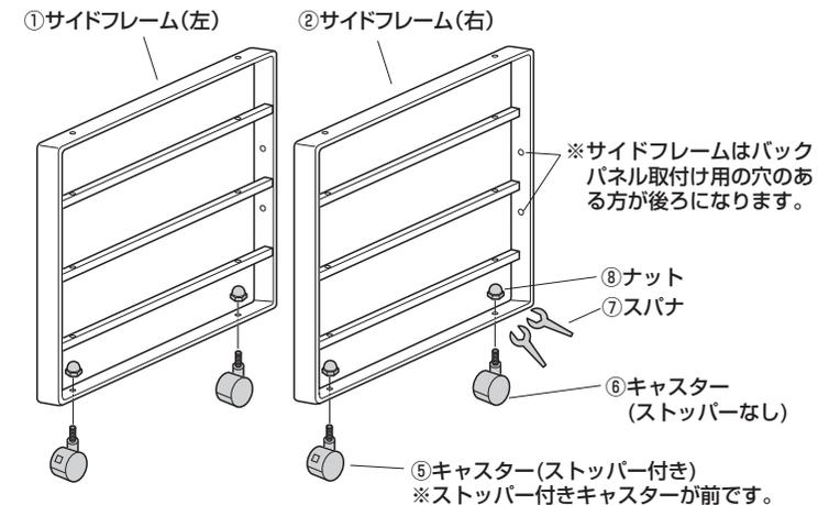
**2 サイドフレームにバックパネルを取付けます。**
