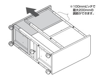
❸ボルトで固定します。 ボルト ※反対側も同様に調節可能です。
