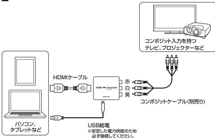
※ご使用機器に合わせてNTSC/PALを切替えてください。(通常はNTSC)
