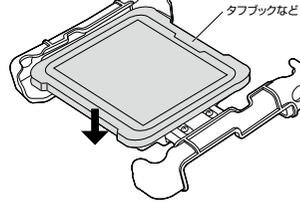
4 ホルダーの背面のレバーを矢印方向に移動させてロックします。
