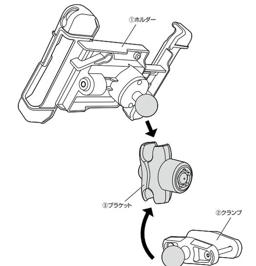
3 しめつけキャップをブラケットの調整リングにかぶせて調整リングを回して固定します。
