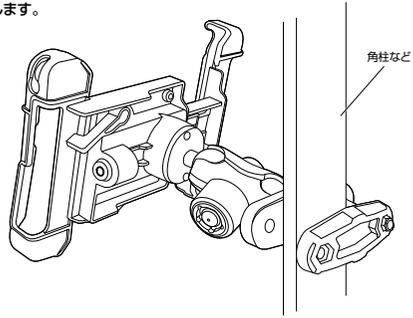
3 先ほど取外したボルトとナットを再び取付けて、両方のボルトを締めつけます。
