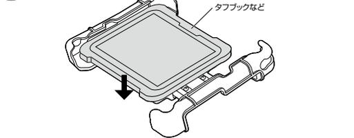
4 ホルダーの背面のレバーを矢印方向に移動させてロックします。
