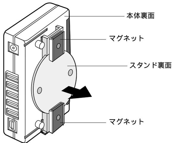
スタンドにマグネットを固定したら、ヨコ置と同様にしてスタンドをハブに取り付け、棚やラック等の金属部分に取り付けて使用します。
