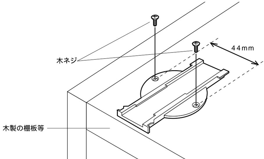
木製の棚板や壁等に取り付ける際は、最初にスタンドの左右の穴にネジを通し、棚板や壁等にスタンドを固定します。
