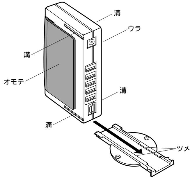
スタンド上面のツメの間にタテにしたハブをカチッと音がするまで通しスライドさせます。ハブ本体にはオモテ・ウラ両面の上下に溝があり、どちらの溝を使ってもスタンドに立てることができます。
