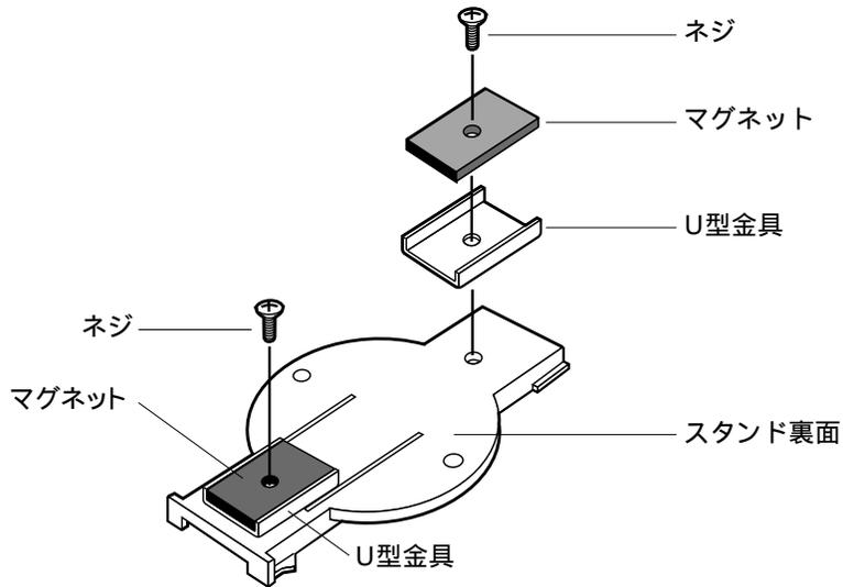
スタンド裏面に図の順番で付属のネジを使ってマグネットとU型金具を固定します。
