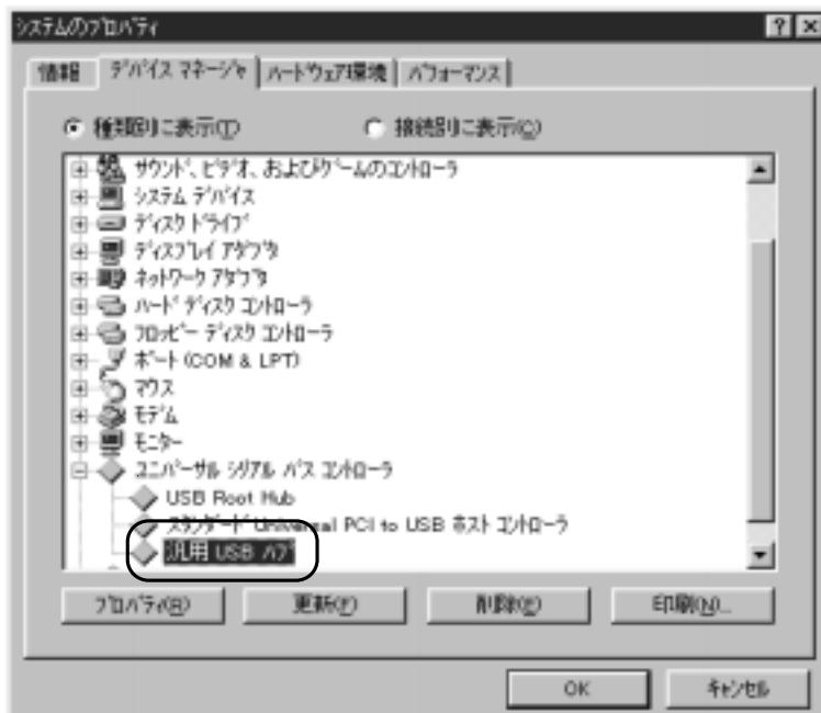
Windows Meの場合、USBハブを接続後USBハブに機器を接続したりパソコンを再起動したりすると、システムのプロパティのデバイスマネージャーで、この「汎用USBハブ」のアイコンに緑色の?(クエスチョン)マークが現れます。このマークを消すには以下の方法でドライバの更新を行ってください。
