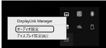
「サウンドのプロパティ」が表示されます。本製品前面のヘッドホンジャック、マイクジャックにそれぞれデバイスを接続するとサウンドのプロパティ内に「USB Dock Audio」が表示されます。
