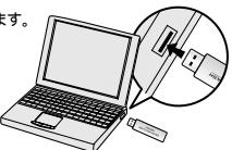
USBコネクタに接続すると、電源&アクセスLEDが点灯しますので、確認してください。
