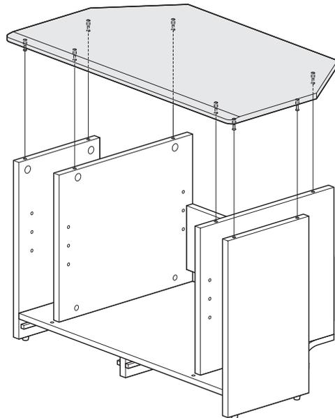
15 締め付け円盤で天板を固定します。
