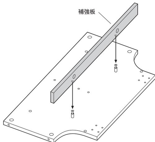
3 締め付け円盤で補強板を固定します。
