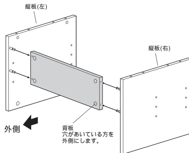
11 締め付け円盤で背板を固定します。
