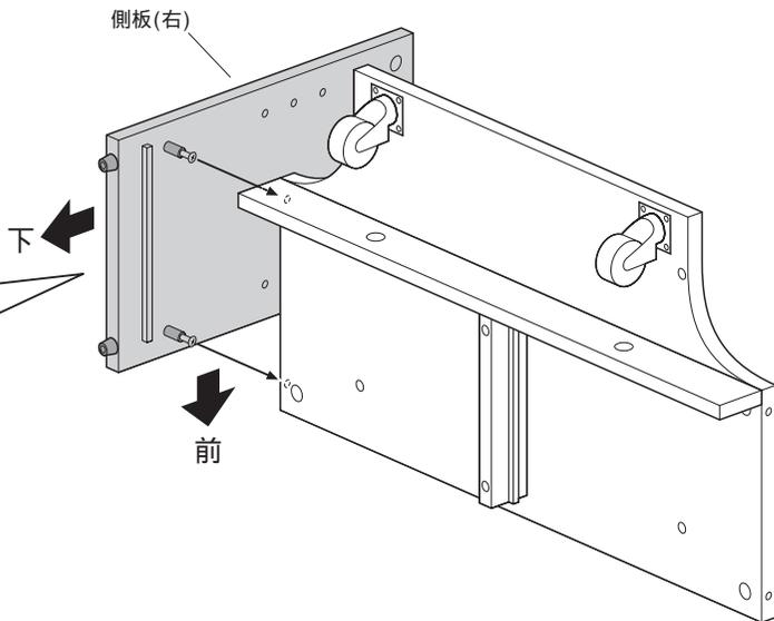
8 締め付け円盤で側板を固定します。
