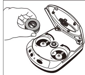
①クリーニングヘッドを本体に取付けてください。(矢印の方向に回して取付けてください。)
