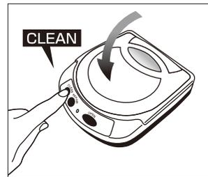
⑤CLEANボタンを押すと、自動的にクリーニングします。(約50秒～60秒で終了して、自動的に停止します。)
