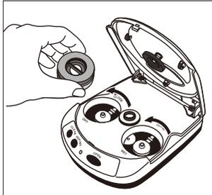
①修復ヘッドを本体に取付けてください。(矢印の方向に回して取付けてください)
