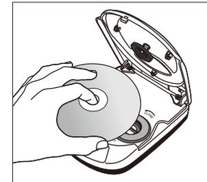
④ディスクの読み取り面を下向きにして、本体の中央(ディスクの置き台)に入れてください。
