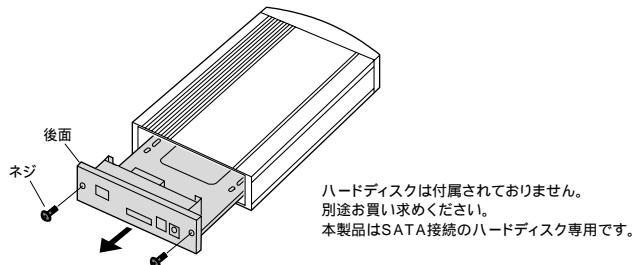
トレイにハードディスクを接続し、付属のハードディスク固定用ネジでしっかりと固定してください。
