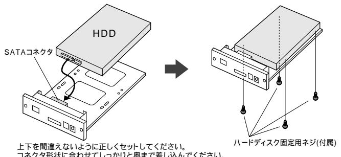
ハードディスクを取付けたトレイをケースに差し込み、再びネジで固定してください。
