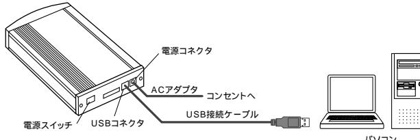
ACアダプタでコンセントに接続し、電源スイッチを入れてください。
