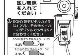
② デジタルカメラによる充電電圧を確認後、スイッチをONにしてください
