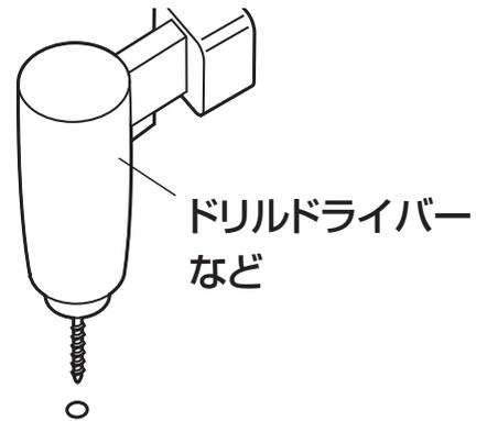
4 再び本製品を取付け部に当てて仮固定用ネジで仮固定します。(4箇所)
