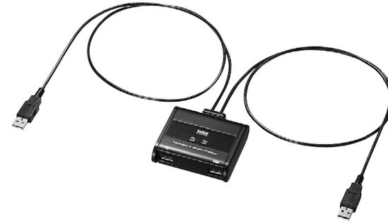
この度は、キーボード・マウス用パソコン切替器(2:1)「SW-KM2UU」(以下本製品)をお買い上げいただき誠にありがとうございます。本製品は、1組のキーボード・マウスを2台のパソコンで切替えて使用するための切替器です。この取扱説明書では、本製品の使用方法や安全にお取扱いいただくための注意事項を記載しております。ご使用前によくご覧ください。読み終わったあとこの取扱説明書は大切に保管してください。
