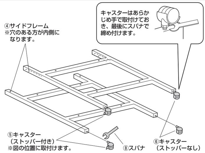
**2 サイドフレームに補強パイプを取付けます。**
