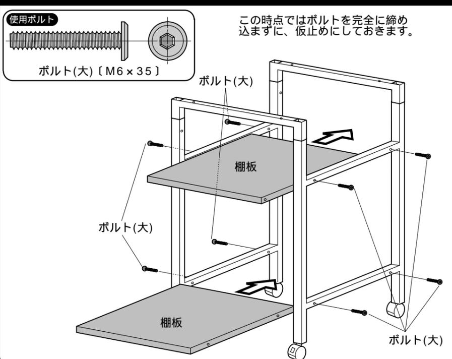
4 天板を取り付け、全てのボルトを締め込んだ後、ボルトキャップを取り付けて完成です。
