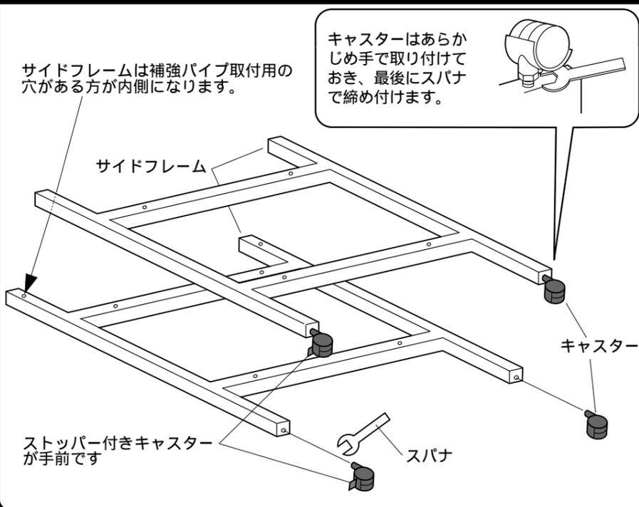
2 サイドフレームに補強パイプを差し込み、ボルト(小)で取り付けます。
