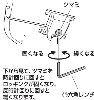
下から見て、ツマミを時計回りに回すとロックが固くなり、反時計回りに回すと緩くなります。
