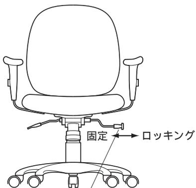
・レバーをイスの正面から見て右方向に引き出すと、ロック機構が働き、逆に左方向へ差し込むとロックができなくなり、固定されます。
