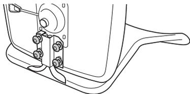
③ 最後に下図の1,2,3,4の順にきつく締め付けます。
